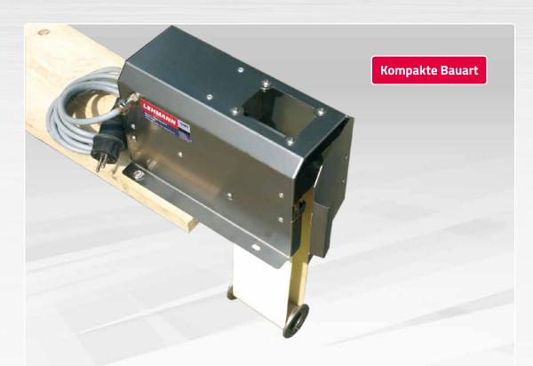
Der Bandskimmer wird überall dort eingesetzt, wo nicht emulgierte Öle und Verschmutzungspartikel von Prozessflüssigkeiten getrennt werden. Primär findet er bei der **Reinigung von Kühlschmierstoffen** für Metallverarbeitungsmaschinen und alkalischen Entfettungsbädern Verwendung. Er eignet sich aber auch zur Reinigung von Prozessflüssigkeiten, bei denen sich freie Öle auf der Flüssigkeitsoberfläche befinden, z.B. Waschanlagen.
