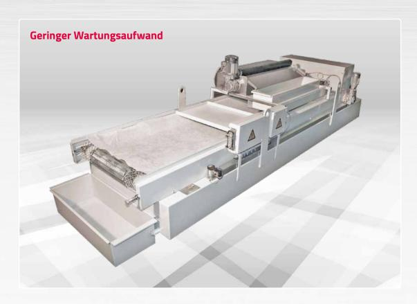
**Lange Standzeit**, geringer Wartungsaufwand, hervorragendes Preis-Leistungsverhältnis sowie eine modulare Bauweise machen den Flachbettfilter besonders attraktiv.
