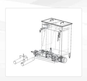
Der Koaleszenzabscheider kommt zum Einsatz, wenn gering partikelverunreinigte Flüssigkeiten von Oberflächenölen und emulgierten Ölen getrennt werden. Hier findet das Koaleszenzprinzip Anwendung. Er eignet sich besonders gut für den **Einsatz an zentralen Flüssigkeitsbehältern**.
